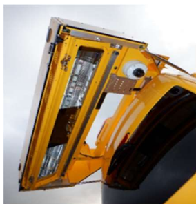
写真-2 新型ロードタイガー後部の 3D ステレオカメラ
