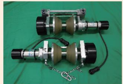
駆動ローラー 斜材直径φ90~200mmに対応
